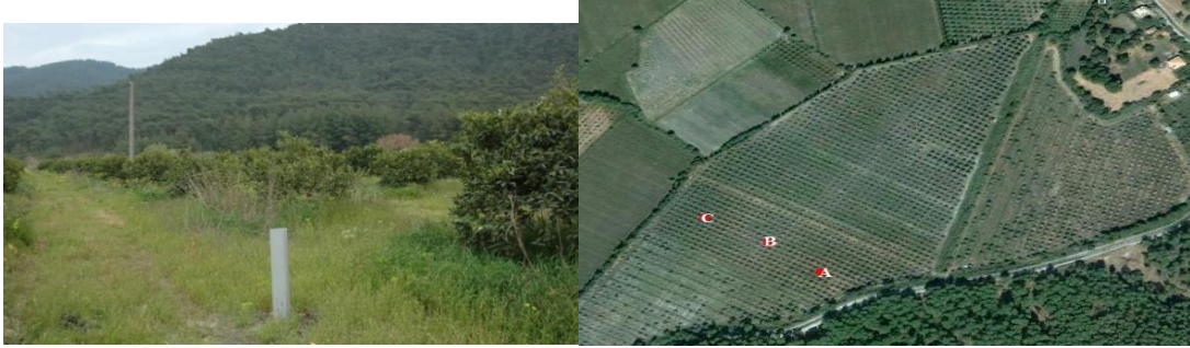
Şekil 2. Taban suyu gözlem boruları ve arazideki konumu
